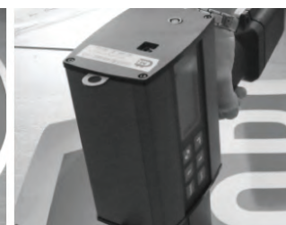
Obr. 8: Reflektometr pro měření retroreflexe
