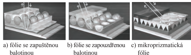
Obr. 6: Druhy retroreflexních fólií
