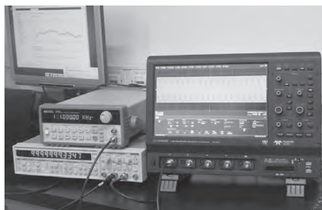
Obr. 2.: Systém pro měření osciloskopů
