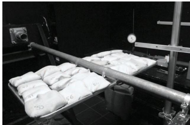
Obr. 5: Zkušební stoličky pro zkoušení odolnosti svislých značek – odolnost proti vodorovnému zatížení štítu značky
