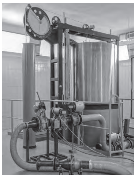
Obr. 1: Státní etalony průtoku plynu Českého metrologického institutu
