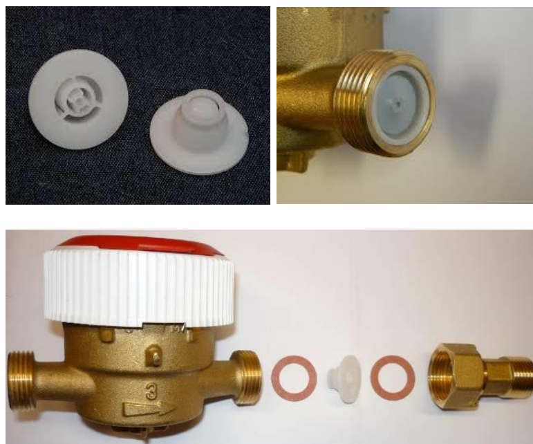
Obrázek č. 1 vkládací zpětná klapka pružinková
