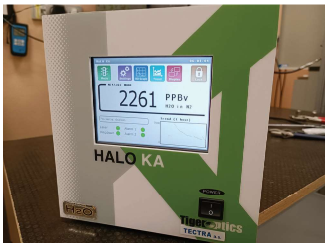
Obr. 10: CRDS laserový spektroskopický vlhkoměr pro měření stopových vlhkostí za zvýšených tlaků
