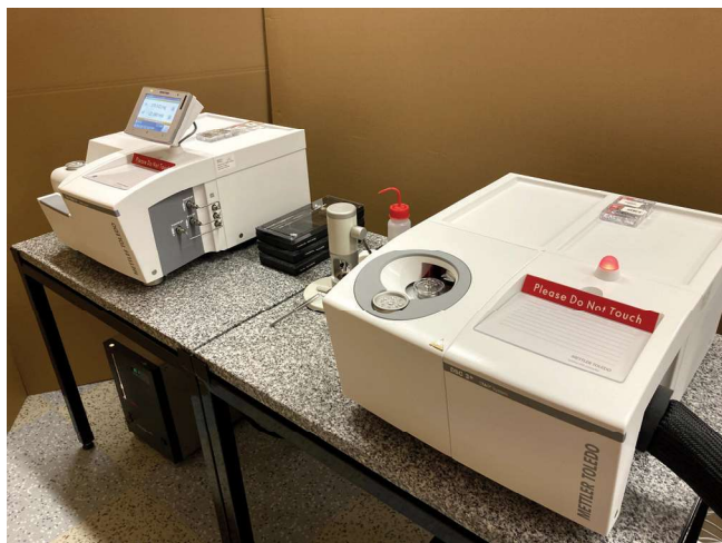
Obr. 6: Přístrojové vybavení laboratoře pro realizaci metod DSC-TGA
