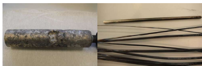
Obr. 11: Vlevo ingot pevného bodu Al po aplikaci v průmyslu, vpravo termočlánek typu K a N po dlouhodobém testu stability
