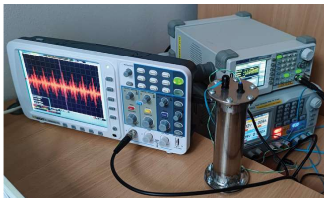
Obr. 9: Vyvíjený zvukový vlhkoměr pro stanovení vlhkosti v tuhých biopalivech
