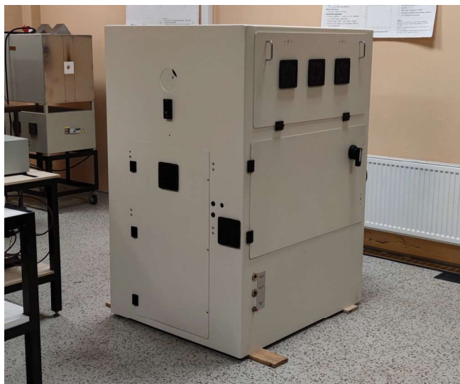
Obr. 4: Vysokoteplotní pec pro teploty nad 2 500 °C
