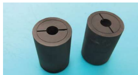
Obr. 3: Eutektické pevné body Fe-C a Co-C
