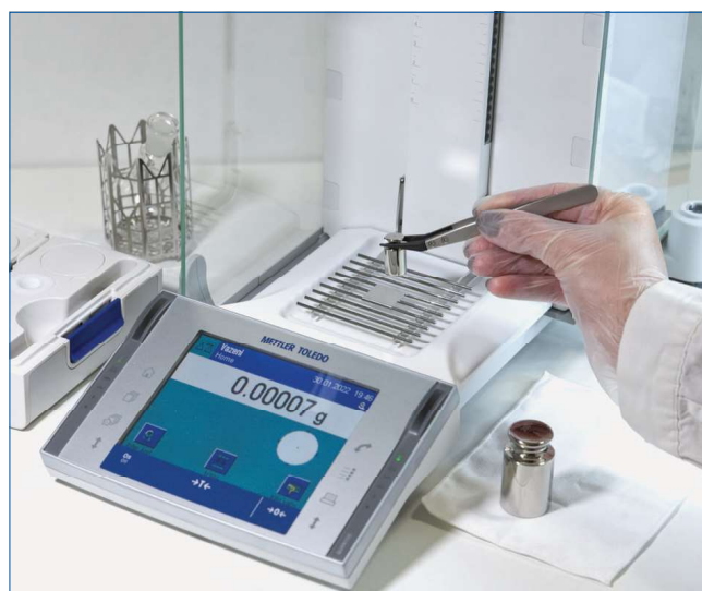
Obr. 4: „Váhy pro analytické účely“. Aby bylo vážení v souladu s předpisy, musí být váhy pravidelně kalibrovány, včetně nejistoty měření, a požadavkem jsou kontroly opakovatelnosti a přesnosti
