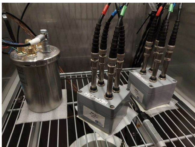
Obr. 7: Část přístrojového vybavení laboratoře pro realizaci kalibrací mostů pro odporovou termometrii (kalibrátor Isotech RBC 100A a referenční odpory)
