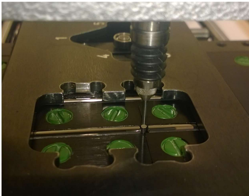
Obr. 2 – Detail na snímače komparačního přístroje
