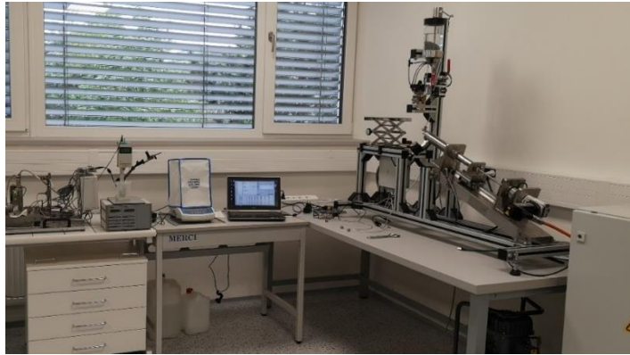
Obrázek 4: Státní etalon v oboru metrologie malých průtoků kapalin od 1ml/h
