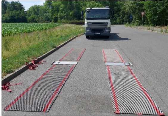
Obrázek 1: Zajištění návaznosti referenčního vozidla pro kontrolu zatížení na nápravách vozidel vážených na vysokorychlostních vahách (WIM)
