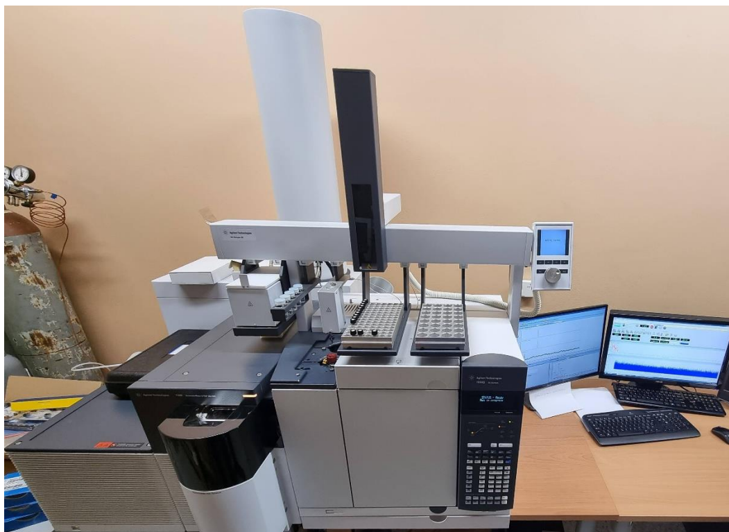
Obrázek 6: Přesné etalonážní zařízení ČMI OI Praha pro analýzu návykových látek
