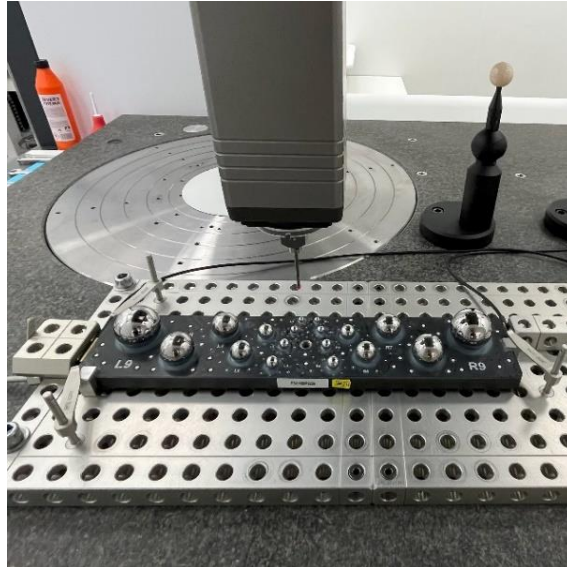
Obrázek 15: Kalibrace specializovaného geometrického etalonu s tvarem koule na Státním etalonu geometrických rozměrů 3D objektů ČMI LPM Praha.
