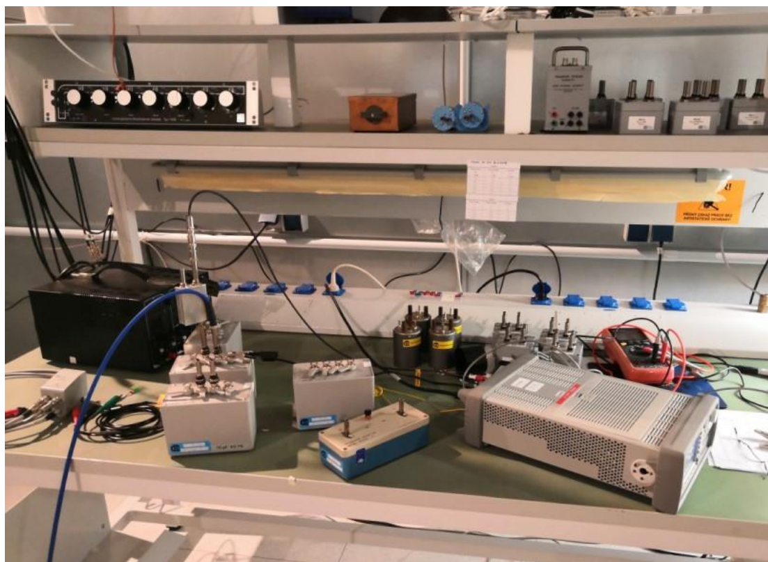
Obrázek 5: Etalonální zařízení pro zajištění metrologické návaznosti měřičů elektrického náboje ČMI OI Praha
