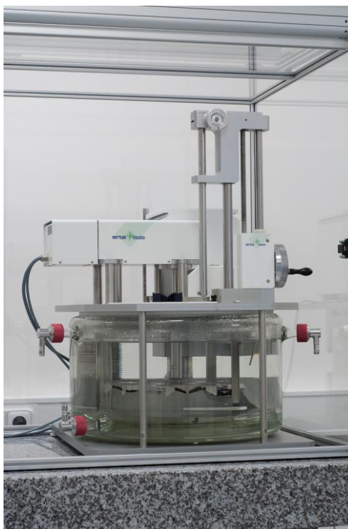
Obrázek 1: Speciální etalonážní zařízení pro hydrostatické vážení používané pro zpřesnění postupu primární etalonáže jednotky hmotnosti v ČMI OI Brno
