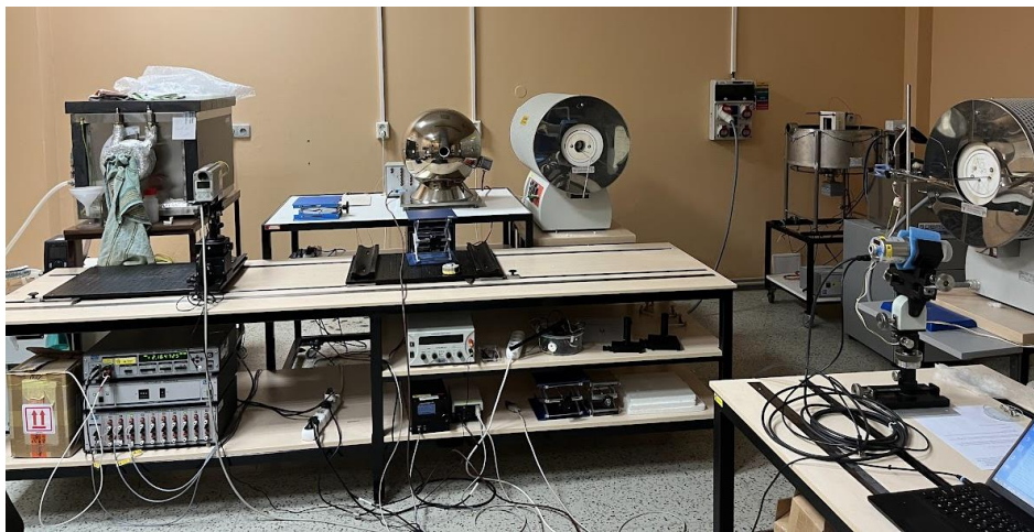
Obrázek 8: Nový systém ČMI pro kalibraci IČ teploměrů, termokamer a černých těles při různých vlnových délkách
