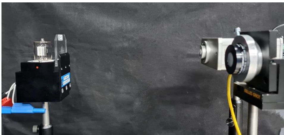
Obrázek 16: Detail měřícího uspořádání pro kalibraci spektrometrů a detektorů pro měření efektivní ozáření erythemy v ČMI LPM Praha
